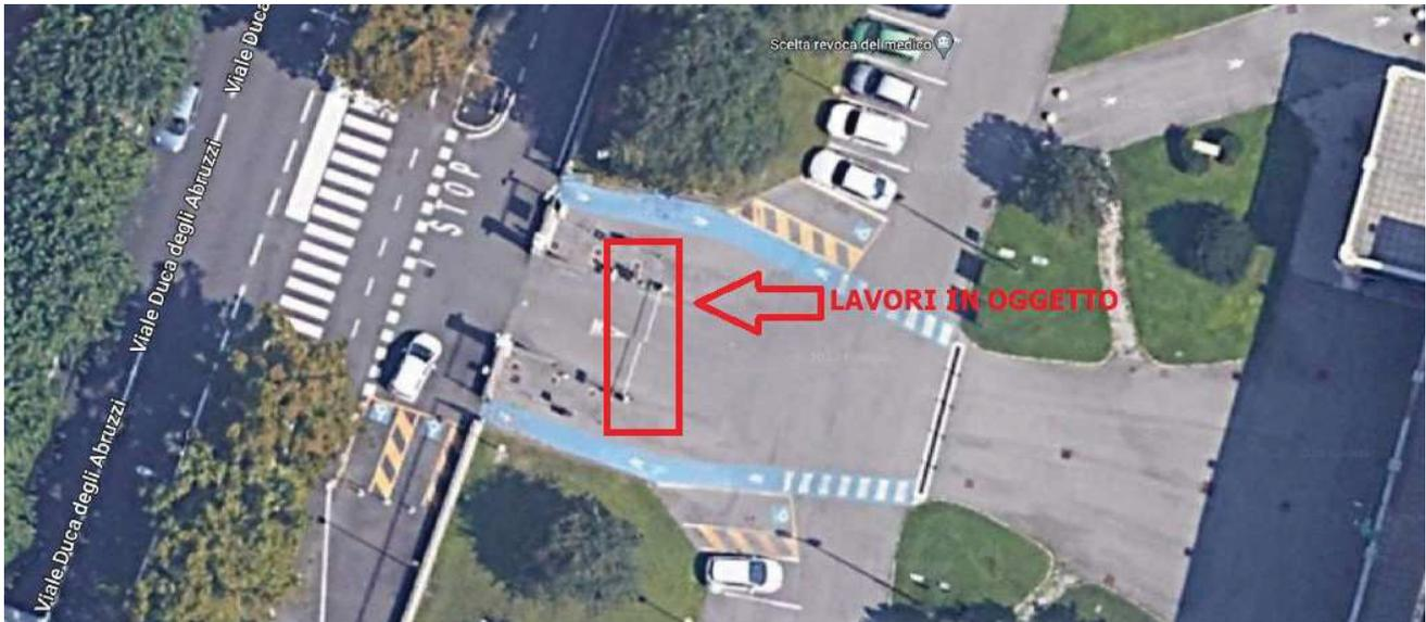
Nella fattispecie è prevista l'installazione di due barriere automatiche alimentate a 230 V. con motori di tipo 24 V. a servizio intensivo, che verranno installate in sostituzione delle barriere esistenti.
