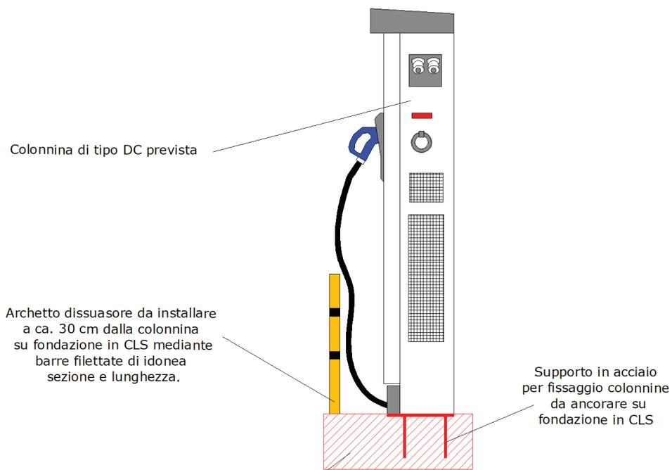
6 – Particolare tipo fissaggio al suolo delle colonnine di ricarica
