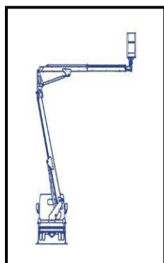
FIG. 1 Esempi di PLE: semovente ragno - autocarrata (gruppo B)
