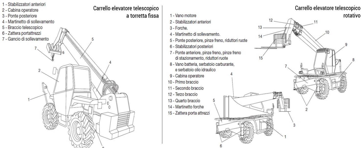
FIG. 1 Esempio di Carrelli semoventi a braccio telescopico
