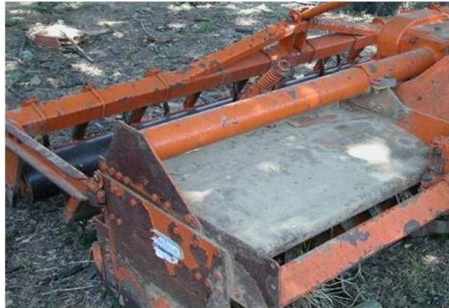
*Fig. 21 – protezione costituita dal rullo posteriore se non azionato*
