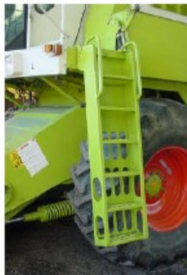
Scala protetta e gradini con superficie antiscivolo
