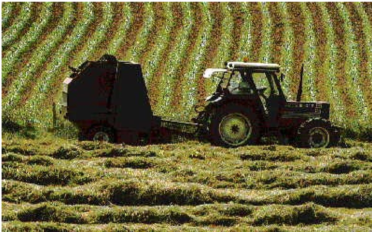
La rotoimballatrice è utilizzata per la raccolta di foraggio, paglia, stocchi di mais ed altro; forma balle di forma cilindrica.
