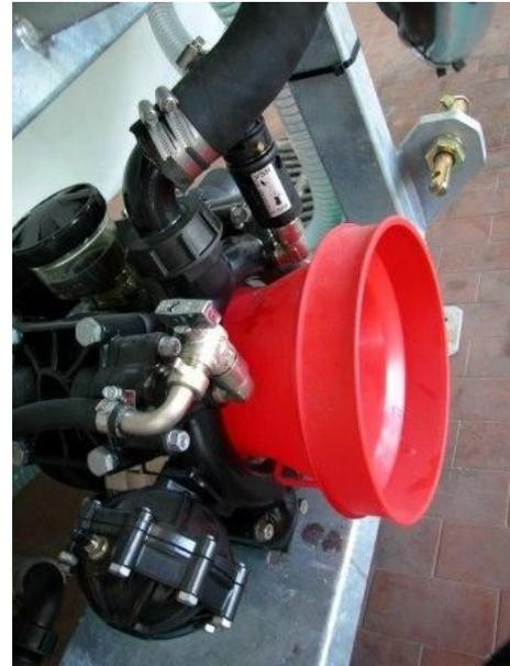
Fig. 7 - *presa di forza con protezione*
