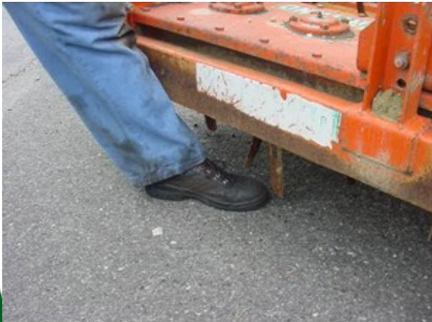
*Fig. 11 - erpice rotante con protezione insufficiente*
