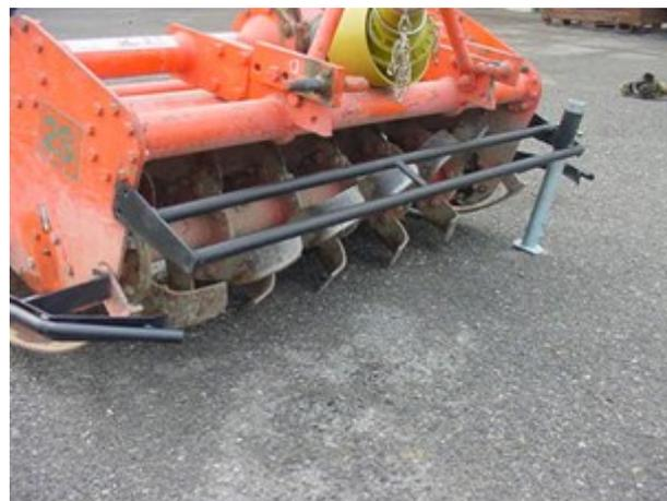
*Fig. 16 - protezione frontale conforme di fresatrice*
