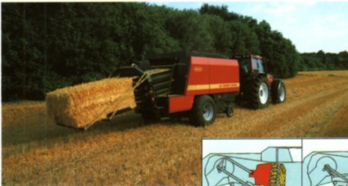
Proceso de llenado de la cámara principal en una empacadora para grandes pacas prismáticas.
