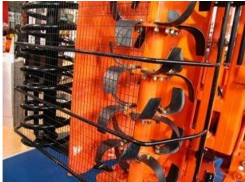
*Fig. 26 - telaio di protezione con griglia per le parti rotanti*
