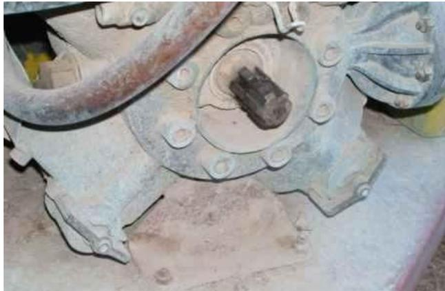
Fig. 6 - *presa di forza senza protezione*
