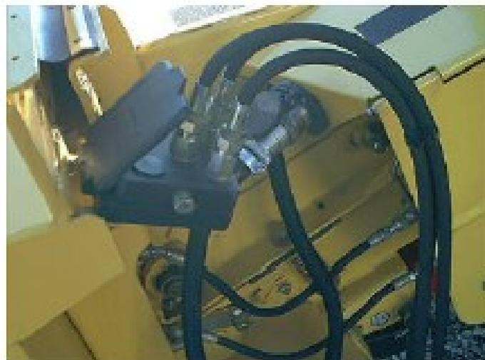
Supporto tubi idraulici
