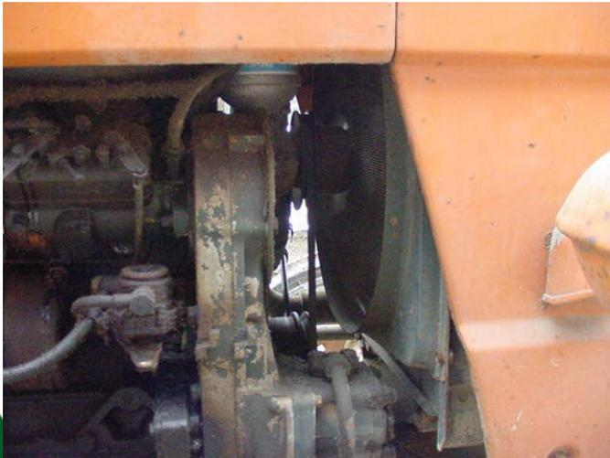
*Fig. 10 - trattrice sprovvista di protezioni delle cinghie pulegge e ventole, dall'origine*
