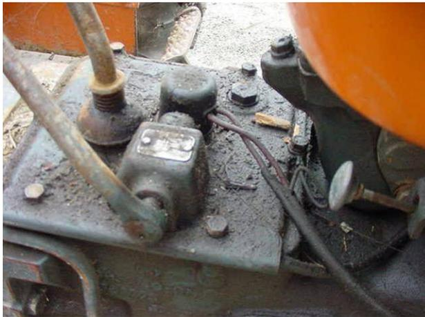
*Fig. 12 - trattoria dove è possibile effettuare l'avviamento della macchina con la marcia inserita*
