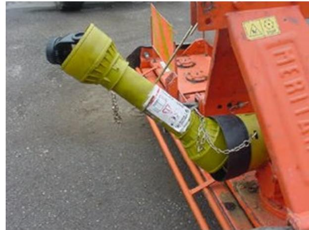
*Fig. 6 - cuffia di protezione della presa di forza conforme*
