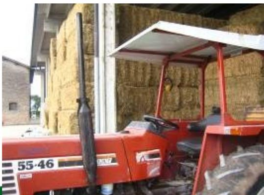
La protezione è necessaria se l'operatore si trova abitualmente in una posizione distante meno di un metro dalle parti calde.
