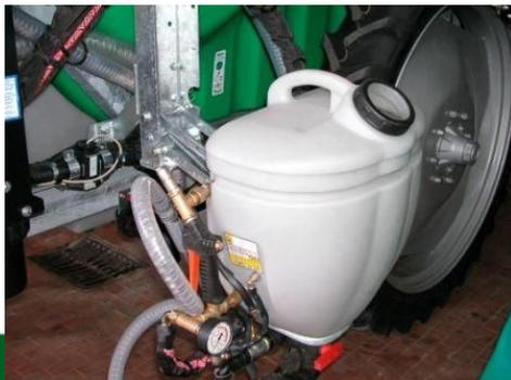
Ogni serbatoio che sia posto sotto pressione deve avere un dispositivo compensatore della pressione per le operazioni di riempimento e di svuotamento. E' prevista quindi una valvola di sicurezza che impedisca alla pressione il superamento di oltre il 20% della pressione massima ammissibile del circuito. La regolazione della valvola di sicurezza deve essere protetta da manipolazioni non autorizzate. (EN 907)
