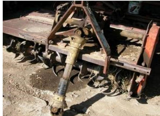
*Fig. 12 - fresatrice senza protezioni degli organi di trasmissione e degli organi di lavoro*
