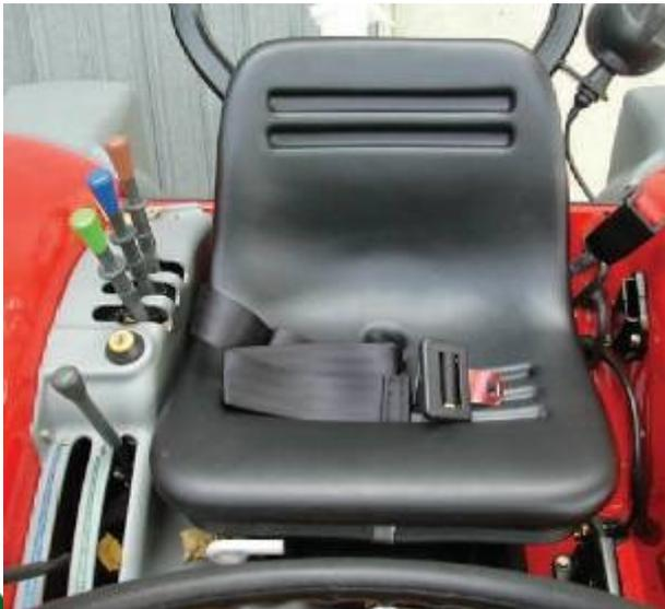
***Sia con la cabina che col solo telaio di sicurezza, è obbligatoria l'adozione di apposite cinture di sicurezza.***
