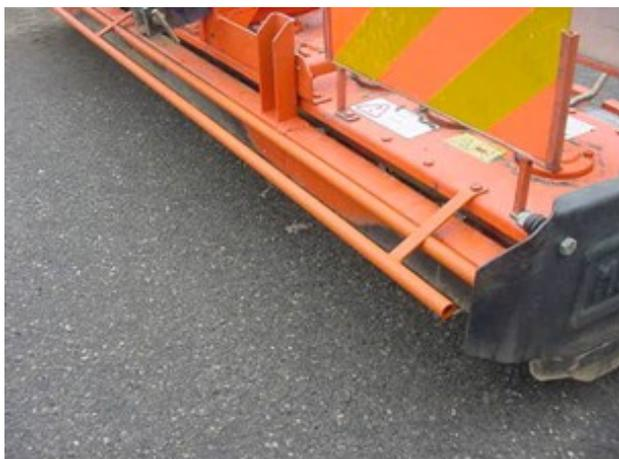
*Fig. 15 - protezione frontale conforme erpice rotativo*
