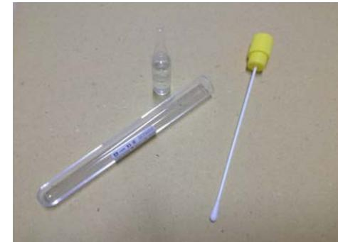
TAMPONE FLEX STERILE IN SOLOZIONE di 5ml fisiologica X AEROSOL POSIZIONAMENTO AL CENTRO DELLA TORRE DI RAFFREDDAMENTO PER UN TEMPO DI 2 MINUTI
