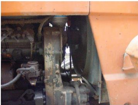
Fig. 10 - trattore sprovvista di protezioni delle cinghie pulegge e ventole, dall'origine
