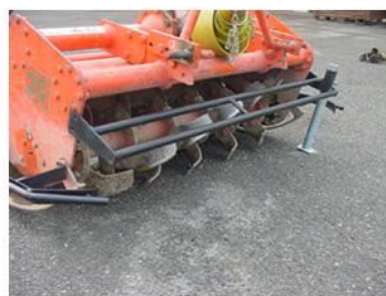
Fig. 16 - protezione frontale conforme di fresatrice
