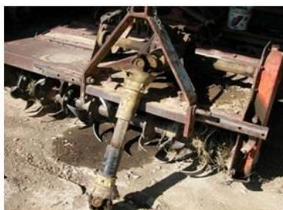
Fig. 12 - fresatrice senza protezioni degli organi di trasmissione e degli organi di lavoro
