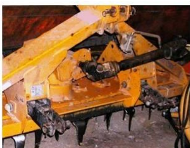
Fig. 5 - cuffia di protezione della presa di forza rotta/mancante
