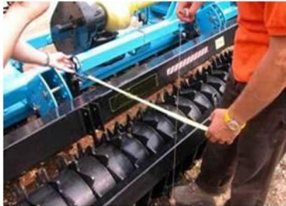
Fig. 22 - la profondità di lavorazione deve poter essere regolata o dal posto di guida o da terra lontano dagli organi di movimento
