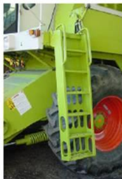
Scala protetta e gradini con superficie antiscivolo
