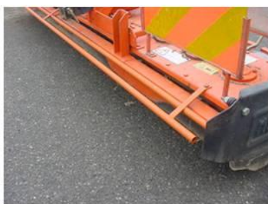
Fig. 15 - protezione frontale conforme erpice rotativo
