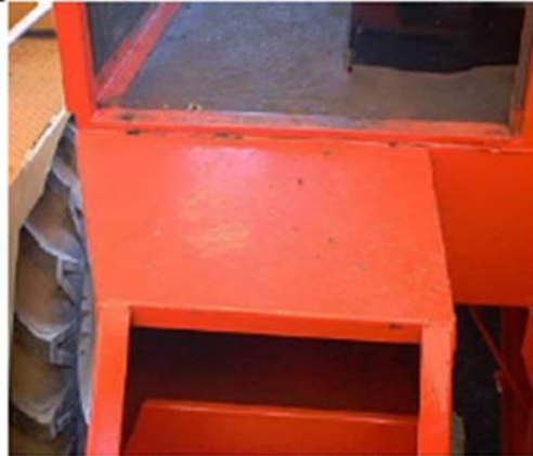
Piattaforma priva di protezioni
