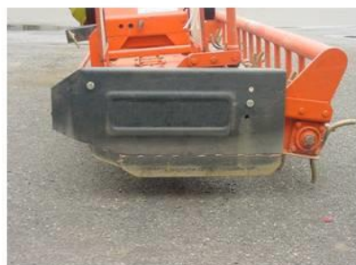
Fig. 18 - protezione conforme: laterale a schermo posizionata ad una quota anche inferiore a 200 mm
