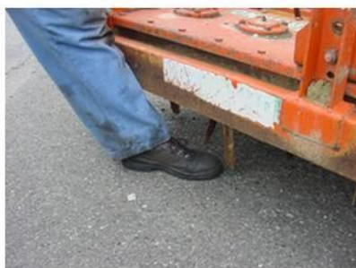
Fig. 11 - erpice rotante con protezione insufficiente
