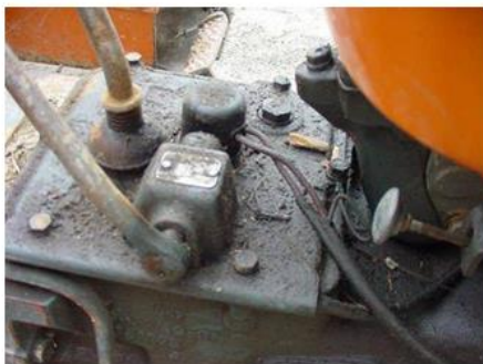
Fig. 12 - trattore dove è possibile effettuare l'avviamento della macchina con la marcia inserita
