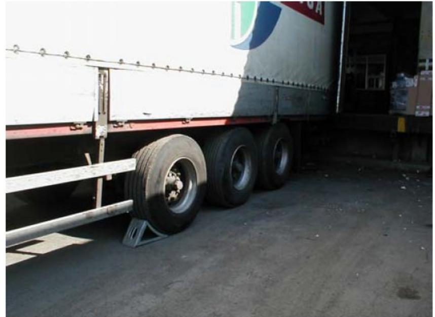
Bloccaggio delle ruote con cunei
