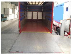
banchina di carico con rampa elettroidraulica
